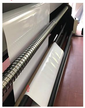
5) Behind the machine, pull out the web 50-60CM
